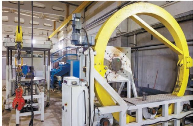
Лаборатория Центра – единственная в Северо-Западном регионе оснащена уникальным оборудованием отечественного производства для проведения испытаний труб больших диаметров – до 1200 мм. Это нестандартное оборудование, которое разработано и произведено в России: установки для определения прочности при тангенциальном и осевом сдвиге трубопроводной продукции, стенд для проведения гидравлических испытаний запорной и регулирующей арматуры.
